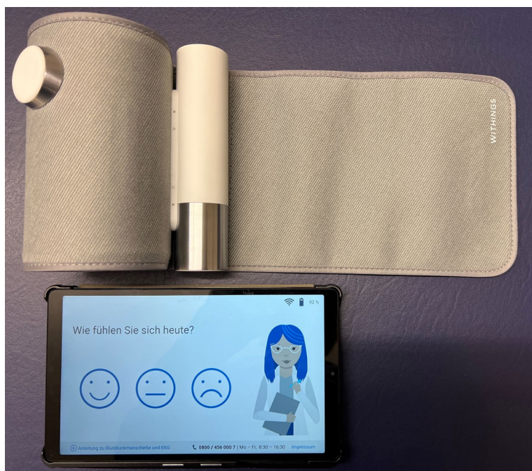
Abb. 1 Beispiel für externe Monitoring-Geräte, die der Patient zu Hause täglich benutzt. Oben: Kombiniertes Blutdruckmessgerät, das gleichzeitig ein EKG aufzeichnet. Unten: Mini-Tablet zur täglichen Frage nach dem Gesundheitszustand: Die Smileys stehen für „gut“, „mittel“ oder „schlecht“. Diese Daten werden vollautomatisch und gesichert sofort übertragen, einschließlich des Körpergewichts (Körperwaage hier nicht abgebildet).
