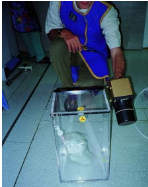
Abbildung 6. Notfalltraining: Im Störfall, welcher zum Beispiel durch unsachgemäße Handhabung (siehe Text) ausgelöst werden kann, muß sofort das gesamte System vom Patienten entfernt und in einem „Notfallkorb“ zwischengelagert werden. Dargestellt ist die Notfallsimulation mit Dosimetrie.
