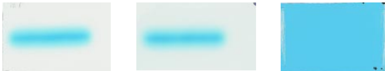
Abbildung 3. Ergebnis der Bestrahlung (jeweils 30 Minuten) des GafChromic™-Films mit den beiden in unserem Katheterlabor befindlichen Strahlenquellen. Man erkennt die homogene Aktivitätsverteilung entlang der Längsachse des Zuges mit rasch abnehmender Dosisleistung entsprechend dem Charakter der Betastrahlen. Rechts das Ergebnis für die Strontiumreferenzquelle (siehe Text).
